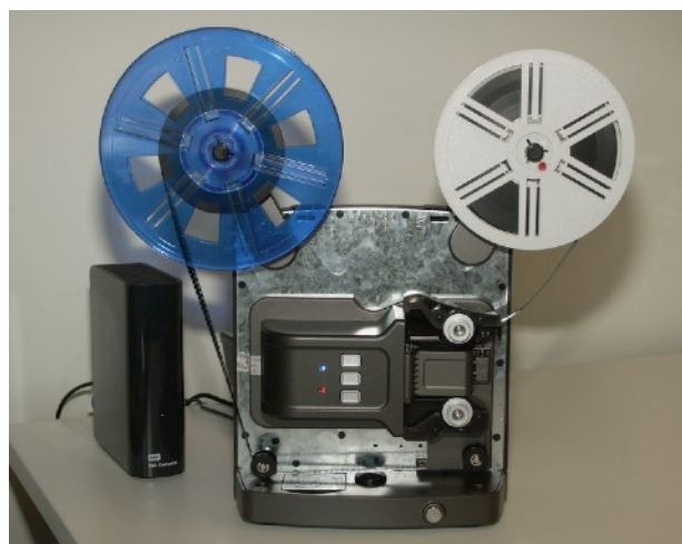
Die neueste Anschaffung: Der Super 8 Film-Scanner Reflecta aus Deutschland. Die Filme im Format Super 8 mm werden direkt ab Filmbild eingescannt, ohne über die Projektion auf einer Leinwand zu gehen. Die Qualität ist somit am höchsten.
