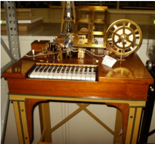
Einer der letzten Hughes Fernschreiber (mit Elektromotor anstelle Gewichtsantrieb)
