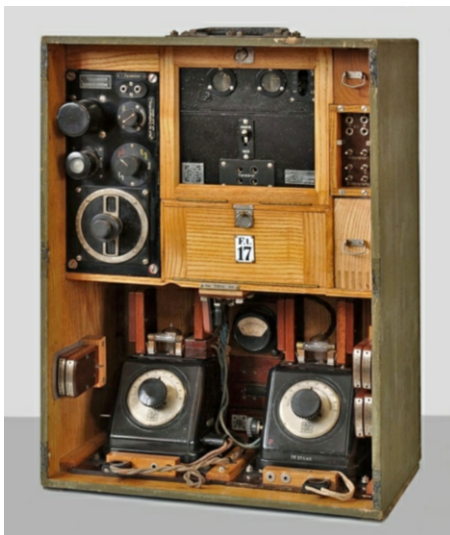
Bild 9: Gerätesatz E 266 – der «neue» Empfänger zum ARS 68 b.
