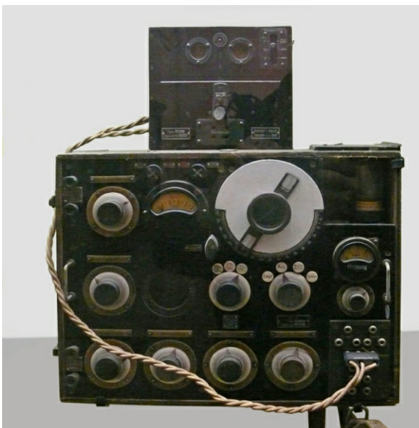
Bild 3: Deutsche Version des ARS 68 mit separatem NF-Verstärker EV 89.
