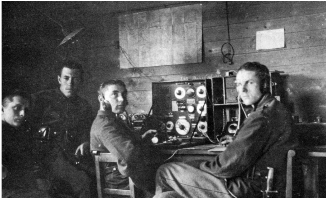
Bild 12: Sender AR 125 mit Empfängerkasten E 266 im Truppeneinsatz , ca. 1925.
