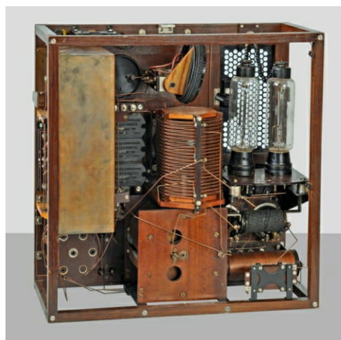
Bild 11: Rückseite des AR 125, rechts oben die beiden Senderröhren RS 5.
