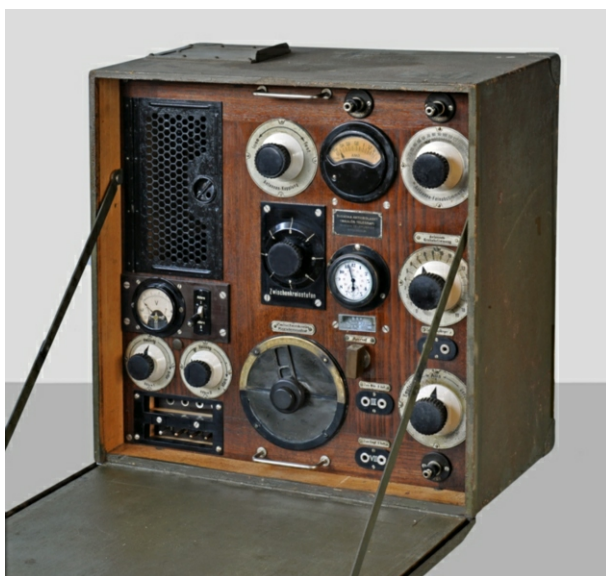
Bild 10: Zwischenkreis-Sender AR 125, mit separatem Modulator auch für Telefonie einsetzbar.
