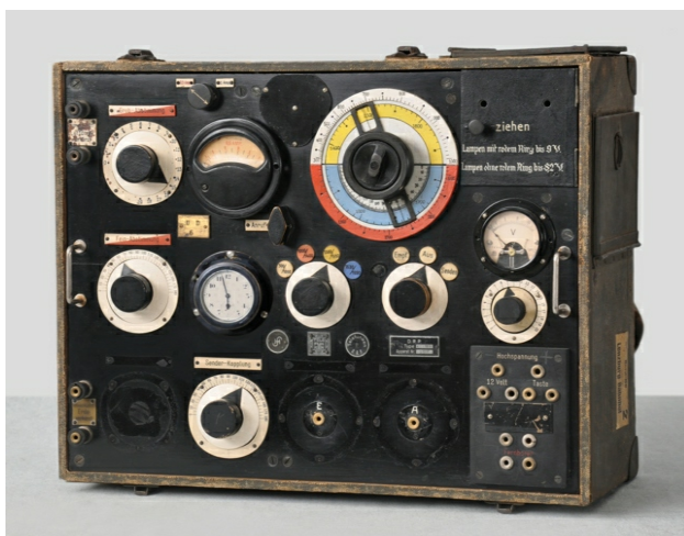
Bild 7: ARS 68 b der Schweizer Armee mit ausgebautem Empfangsteil.
