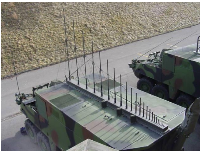
Prototyp des VHF Störsenders
