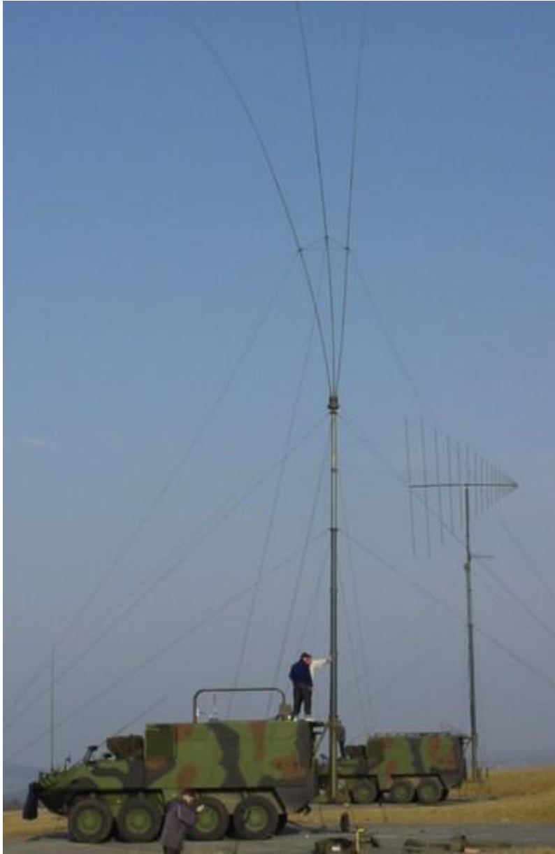
Stationäre Antennen: Vorne Vertikal – HF – Dipol hinten Vertikale VHF Logger Antenne
