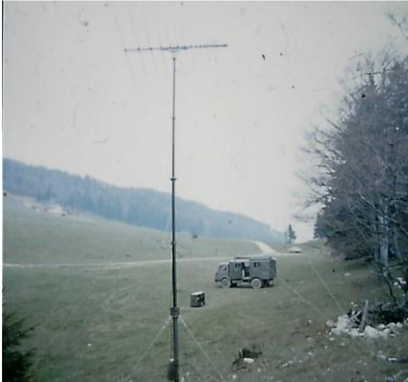
Logper-Antenne, Aggregat und Trägerfahrzeug für den Labor-Störsender GROSSO
