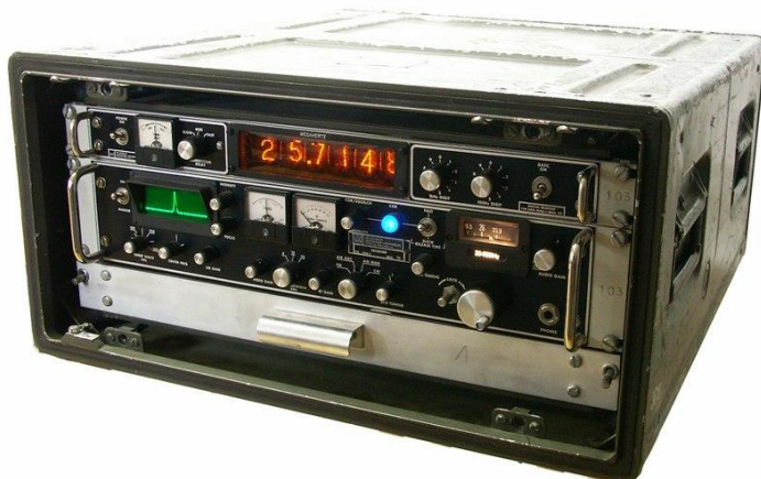
VHF Empfänger E-649 20...80 MHz ermöglicht werden.
