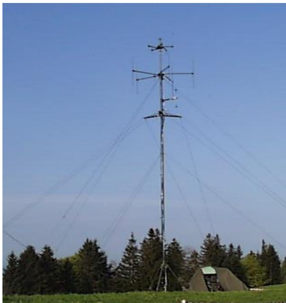
Peil- und Analyseantenne mit zugehörigem Gerätesatz (im Zelt)
