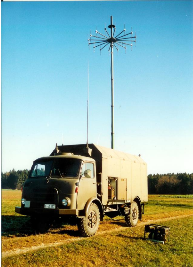
Messfahrzeug AUEM Typ B (Empfang) mit Prototypversuch Doppler-Peiler R&S
