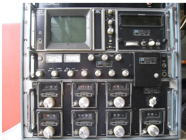
Empfangssystem watkins johnson RS-160 20...1000 MHz, der grosse Bruder vom VHF Empfänger E-649
