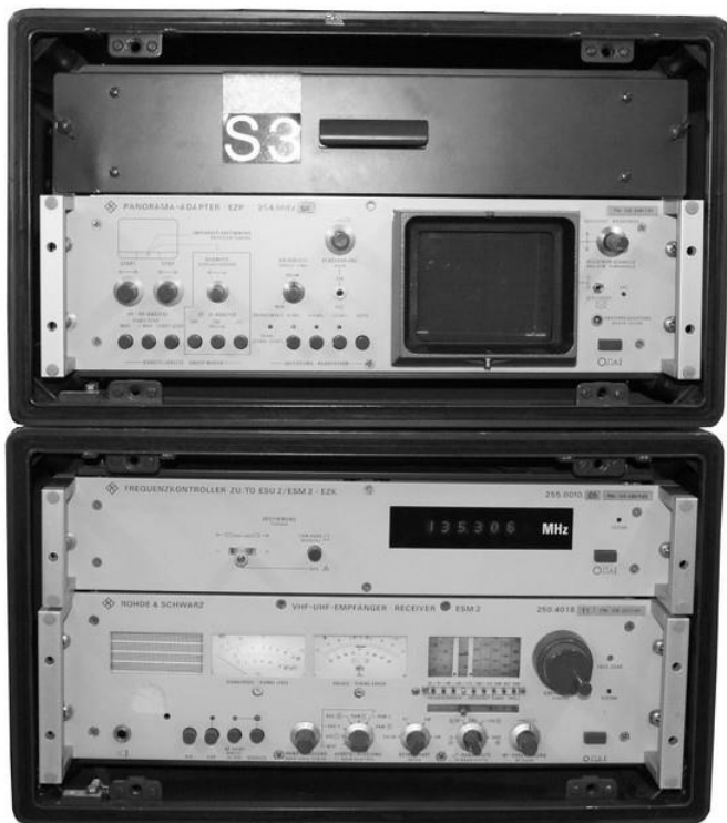
V/UHF Empfänger E-652: unten Empfänger, Mitte Frequenzcontroller, oben Panoramagerät
