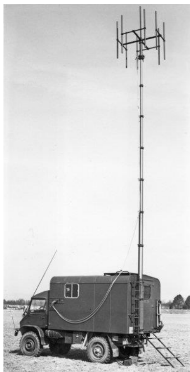
Peiler mit Teleskopmast und Adcock-Antenne
