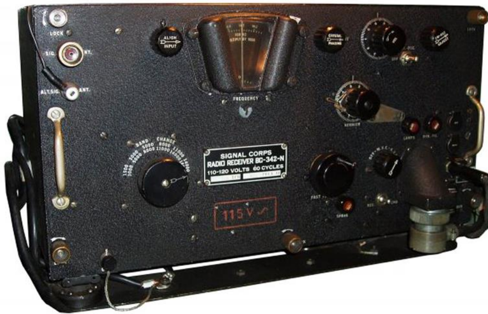
1950er-Jahre - war u.a. auch dieser Kurzwellenempfänger von der US Army Signal Corps , BC-342-N , von 1.5-18 MHz in 6 Bereichen im Botschaftsfunk in Betrieb. Konstruktionsjahr: 1936 Beschaffung: 1948
