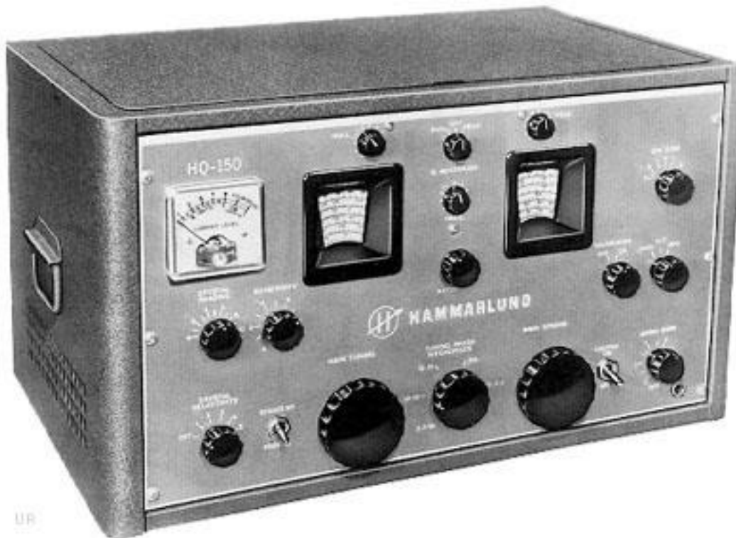
1950er-1960er-Jahre - im BF verwendete man u.a. auch diesen Kurzwellenempfänger, Hammarlund HQ-150 , 540 kHz-31 MHz in 6 Bereichen mit Bandspreizung. Hergestellt: 1956-1958
