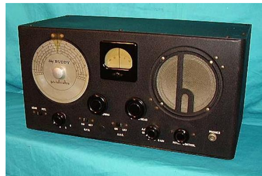
Amateurgerät KW RX Hallicrafters S-19R, 1938
