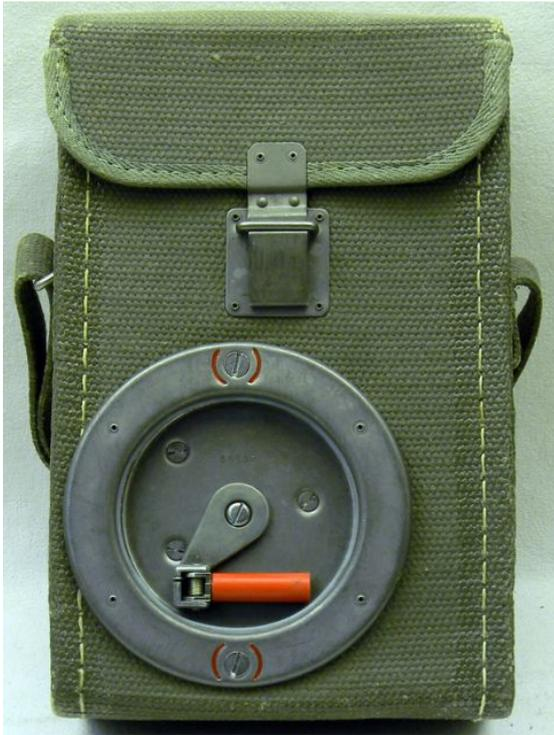
Ausführung wie das Standardmodell 50A, Beschriftung auf der linken Seite mit einem 60 mm hohen Z, die Querlasche unter dem Deckel sowie die Füße unten am Segeltuchetui fehlen und der Tragriemen ist beidseitig fix mit dem Gehäuse verbunden. Abmessungen 15 x 10 x 22.5 cm, Mikrotelefon fest angeschlossen. Originalgeräte sind mit 80000er Nummern beschriftet. Nachträglich wurden Feldtelefone 50A mittels Schablone um beschriftet und als Zivilschutzapparate gekennzeichnet.
