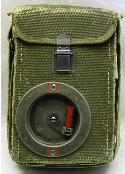
Die Standardausführung und mit 12398 Geräten das meistgebaute Modell. Abmessungen 15 x 10 x 22.5 cm, Mikrotelefon fest angeschlossen.
