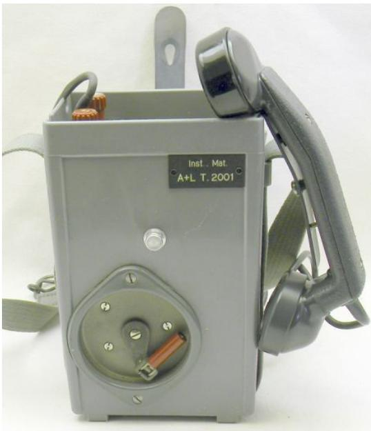
Einschub Modell 50A ist montiert in ein massives hellgraues Kunststoffgehäuse. Der Deckel, fixiert hinten mit zwei Gummiteilen, wird vorne mit einer Gummilasche verschlossen. Für die Kabelzu- und wegführung sind im Deckel und am Gehäuse Aussparungen angefügt, dadurch ist der Behälter nicht dicht. Der Stoff-Tragriemen kann aufgetrennt werden.
