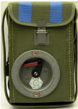
Sondermodell mit blauen Streifen und Buchstaben B auf dem Deckel, verwendet beim Flieger Beobachtungs- und Meldedienst, 195 Stück wurden gebaut. Abmessungen 15 x 10 x 22.5 cm, Mikrotelefon und Zusatzhörer fest angeschlossen. Originalgeräte sind mit 6000er Nummern beschriftet.
