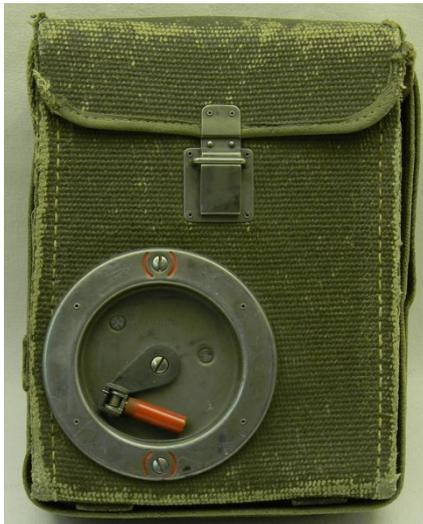
Sondermodell mit breitem Gehäuse, jedoch ohne Beschriftung und farbigen Streifen. Abmessungen 17 x 10 x 22.5 cm, Sprechgarnitur und Mikrotelefon (in separatem Segeltuchetui) über Steckverbindung angeschlossen. Originalgeräte sind mit 30000er Nummern beschriftet. Dieser Apparat beschaffte die PTT für ihre Monteure für Arbeiten im Zusammenhang mit der Bereitstellung von Leitungen für die Armee.
