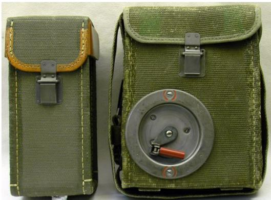
Sondermodell mit grünen Streifen und Buchstaben D auf dem Deckel, verwendet bei den Infanterie-Nachrichten-Kompagnien, 1115 Stück wurden gebaut. Abmessungen 17 x 10 x 22.5 cm, Sprechgarnitur und Mikrotelefon (in separatem Segeltuchetui) über Steckverbindung angeschlossen. Originalgeräte sind mit 20000er Nummern beschriftet, allerdings sind auch ganz niedrige dreistellige Nummern sowie 10000er Nummern möglich. Das deutet auf nachfabrizierte Apparate hin.
