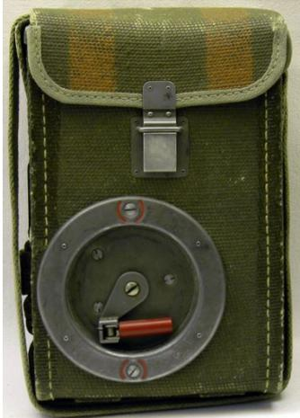
Sondermodell mit braunen Streifen und Buchstaben C auf dem Deckel, verwendet bei der Infanterie-Flab, 400 Stück wurden gebaut. Abmessungen 15 x 10 x 22.5 cm, Sprechgarnitur über Steckverbindung angeschlossen. Originalgeräte sind mit 7000er Nummern beschriftet.
