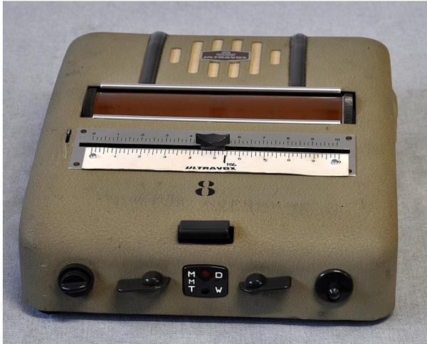
Das Diktiergerät «Ultravox». Die Walze mit der eingelegten braunen Folie dreht mit 20 U/Min. Aufnahmezeit etwa 30 Minuten. Dann wird die Folie wieder überschrieben. Der weisse Indexstreifen kann beschrieben und abgenommen werden.
