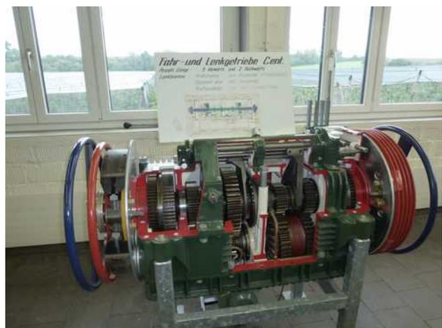
Fahr- und Lenkgetriebe Centurion Panzer
