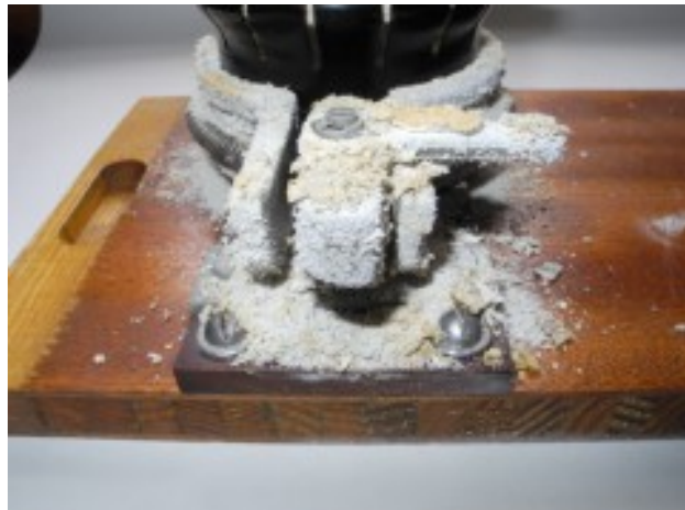
Halterung einer Senderröhre von Zinkfrass befallen
