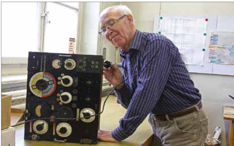
Edi Willi begutachtet den neuangekauften Sende-Empfänger ARS 68b, Nr. 13207. Es handelt sich um ein sehr gut erhaltenes Exemplar des ersten Sende-Empfängers in Röhrentechnologie der Schweizer Armee aus dem Jahre 1918/19.
