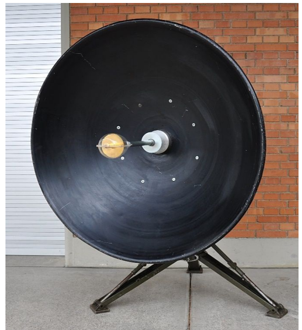
Parabolspiegel (Antenne) mit Dipol zur Richtstrahlanlage RB-1111
