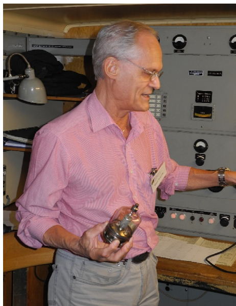
René Schmitt präsentiert eine Senderröhre aus der Funkstation SE-406 Röhrentyp: 4-125A von EIMAC / USA
